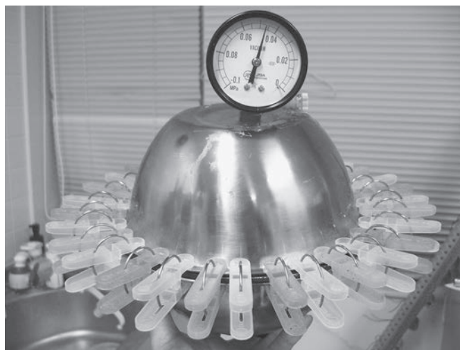
図－4 ステンレスボールで作った「マグデブルクの半球」。洗濯ばさみは上下のボールの仮止め用である。
